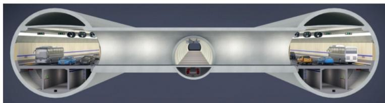
胶州湾第二隧道采用双向六车道主线隧道加中间服务隧道的方式进行布置。
