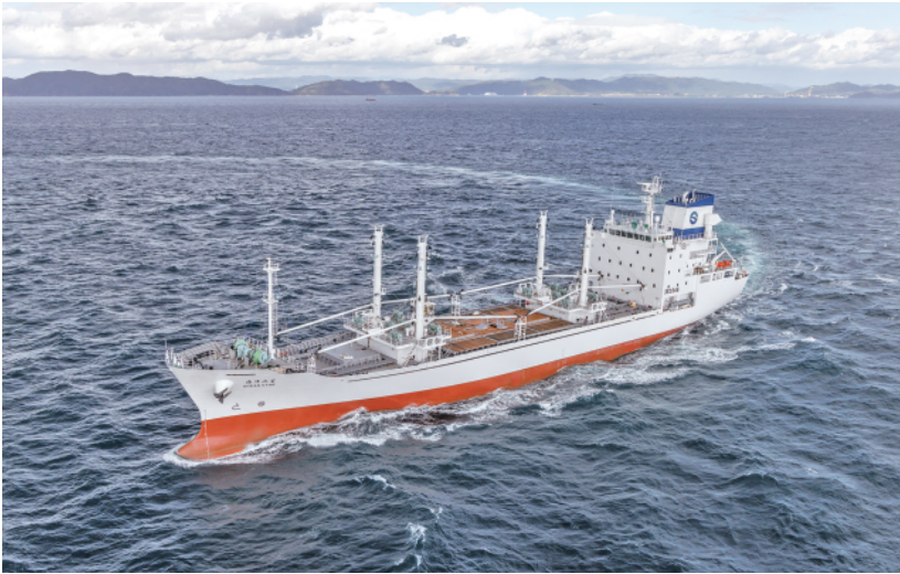
“海洋之星”船长117.5米,总吨位5350吨,蓝鳍金枪鱼日加工能力约55吨。
