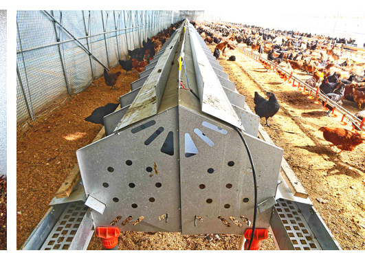
自动化集蛋系统会将鸡蛋快速收集运送到鸡舍墙外。
