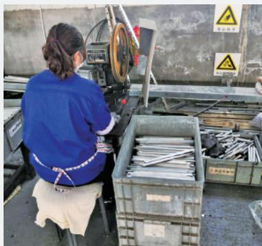
**存在问题:**青岛百斯特电器有限公司——小冲床电机皮带传动轮防护罩安装未到位。
