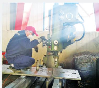
**存在问题:** 青岛庆霖工业品有限公司——钻床操作工手套使用有误,应教育员工正确使用防护用品。
