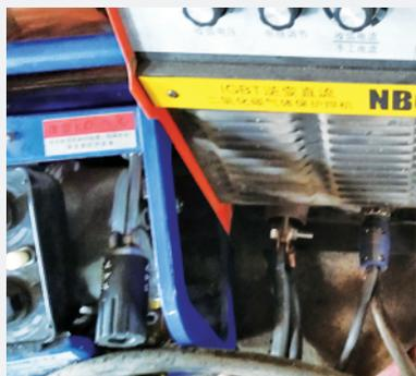
**存在问题:** 青岛兴源盛数控有限公司——电焊机进线端无防护。
