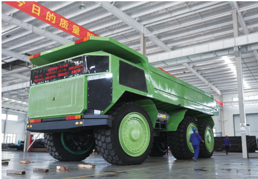
150吨级无人驾驶智能矿山自卸车仅一条轮胎就高达2.5米。□记者 刘腾 摄
