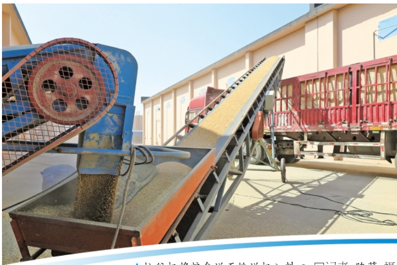
▲扒谷机将粮食送至输送机入料口。□记者 陈蔚 摄
