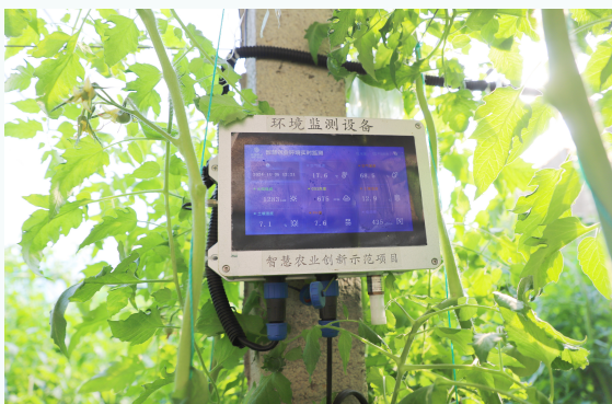
▲智能监测设备可实时显示棚内温湿度等数据。
