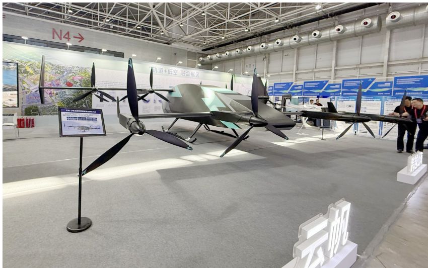
▲青岛蔚蓝空间飞行器有限公司自主研发的“云帆-2”电动倾转旋翼垂直起降飞行器
